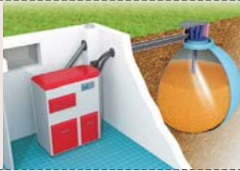
Externer GFK-Tank mit pneumatischer Förderung
