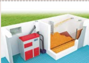
Umgebauter Tankraum mit Schnecken- förderer
